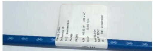
Prüfetikett an der Kaltanschlussleitung befestigt.
